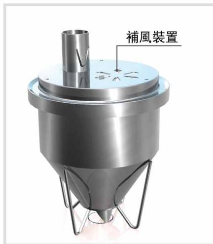
**補風裝置：**在吸料前手動把補風裝置打開，可以根據吸料情況調整補風口的大小，方便吸料。
