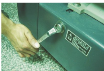
图 6-18: V 形带的调整图二
