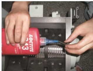
图 6-9: 维修保养刀具图
