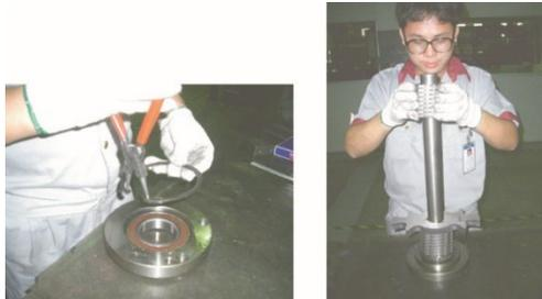
图 6-12: 定刀与动刀的安装示意图一
