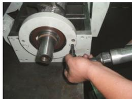
图 6-13: 定刀与动刀的安装示意图二
