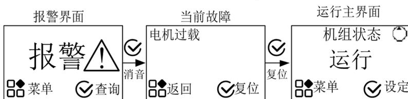
图 4-11: 多功能控制箱查询/复位故障
