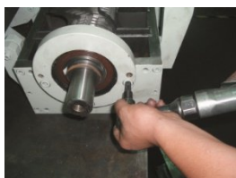
图 6-13: 定刀与动刀的安装示意图二
