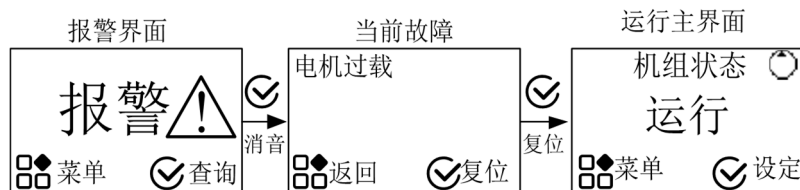
图 4-10: 多功能控制箱查询/复位故障
