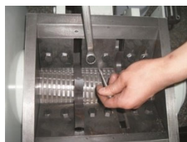
图 6-14: 定刀与动刀的安装示意图三
