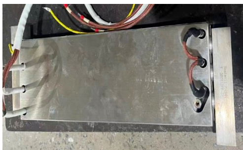
图 6-9: 清洗非接触式电热管一
