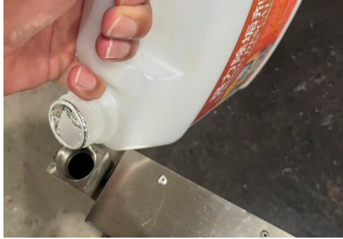
图 6-11: 清洗非接触式电热管三
