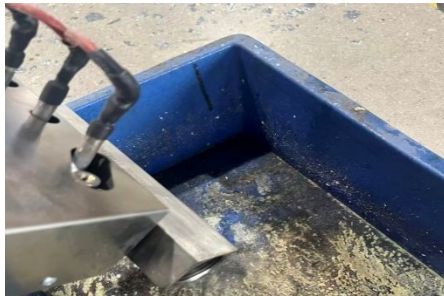
图 6-13: 清洗非接触式电热管五
