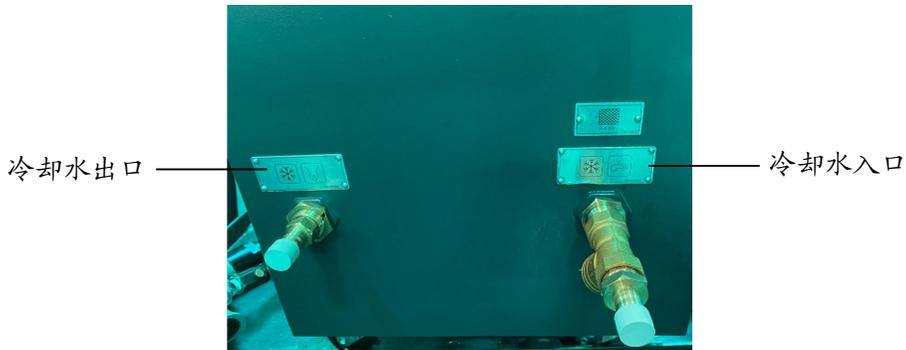
图 3-2: 管路的连接
