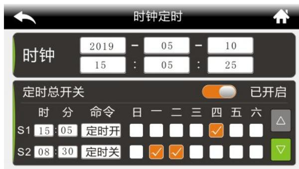
图 4-9: 设置定时开关机画面
