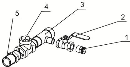
1、气管快速接头    2、球阀    3、气吹接头    4、单向阀3/4"    5、3/4"铜尼不了
