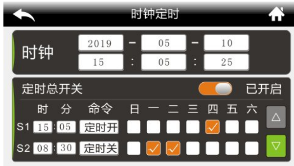
图 4-8：设置定时开关机画面
